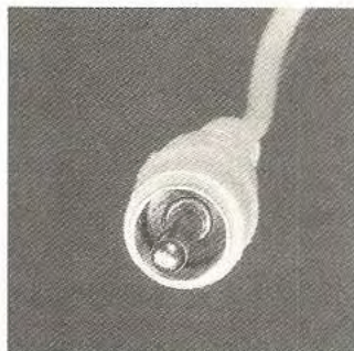
Bild 1. Cinch-Stecker, wie sie viele Monitore (z. B. der 1702) verwenden
